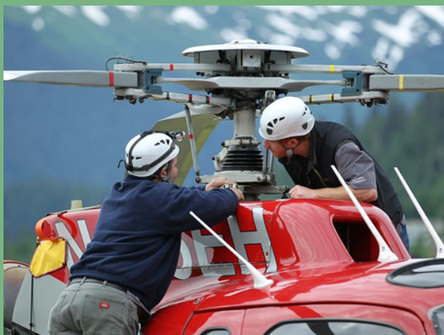
Operação de montagem e ajuste do rotor e das pás do helicóptero
