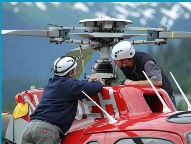
Operación de montaje y ajuste del rotor y las palas del helicóptero.
